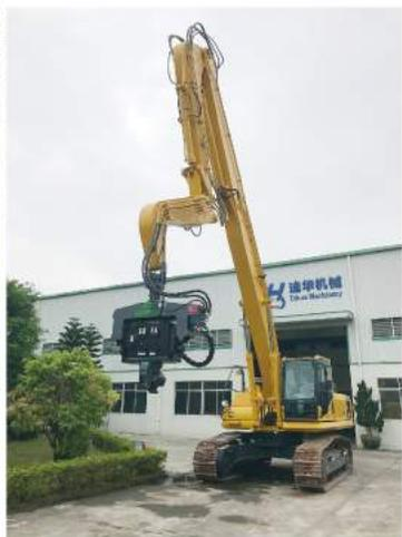
ICE 8RF5H 挖机锤机身小巧, 激振力强劲, 侧旋转方便夹板, 提高工作效率, 超高频的振动对周围环境无任何影响, 尤其是工作时极小的声音, 颠覆了用户对传统挖机锤工作噪音的认知, 给予高度的肯定。
